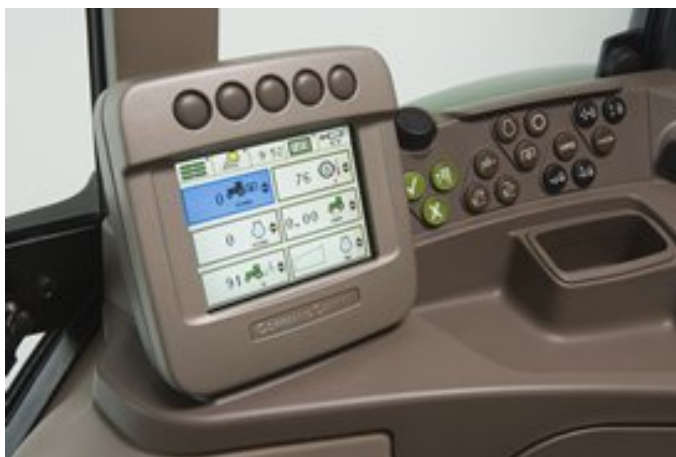
Abbildung 2.5: Gesamtübersicht eines Command Center in einem John Deere 6030 Premium [John Deere 2013]
