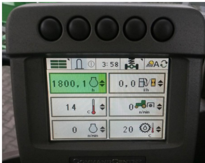
Abbildung 2.4: Bildschirm eines Command Center in einem John Deere 6030 Premium [John Deere 2016]
